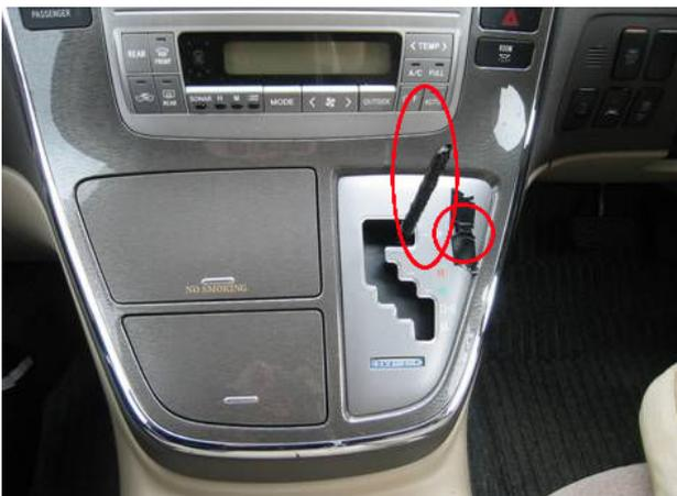
コンソールパネルを外す前に、シフトのねじ部でパネル等を傷つけない様にテープで養生します。シフトロックボタンは落下させないように、テープで固定しておきます。
